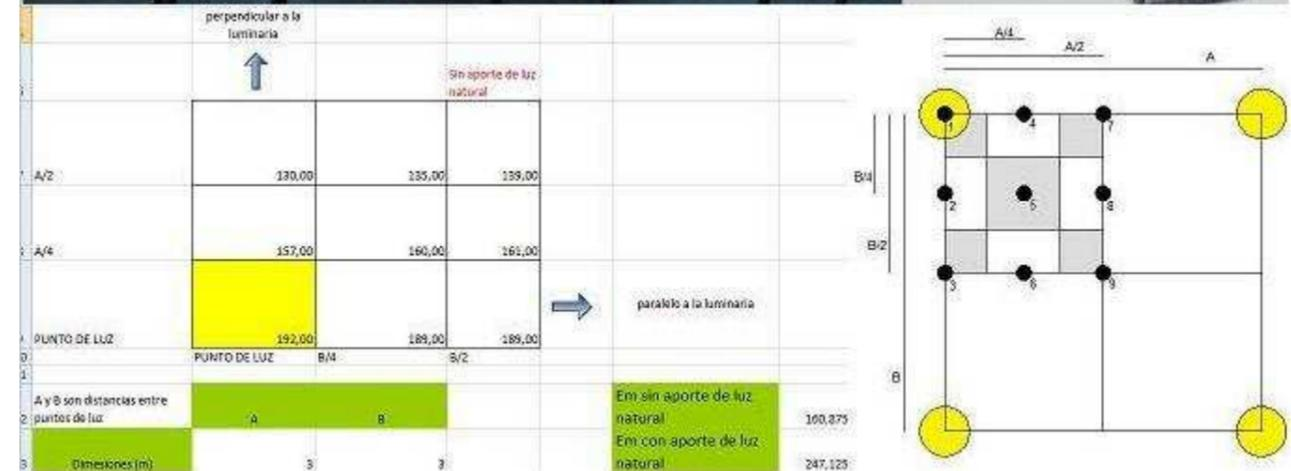
Medición de iluminancia media con luxómetro a través de malla de 9 puntos a nivel de mesa
