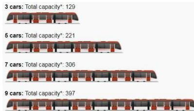
*Ejemplo de una plataforma modulable de un fabricante*
