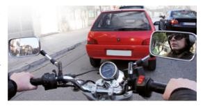
La técnica más adecuada es iniciar levemente la frenada con el freno trasero para posteriormente iniciar el delantero.
