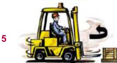
Cuando las puntas de las horquillas están a unos 30 cm de la carga, inclinar el mástil hacia atrás y girar para conducir de frente.
