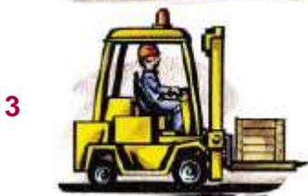
Descender la carga al suelo, y bajar las horquillas unos centímetros más para desprenderlas del palet.
