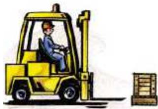
Acercarse, de forma perpendicular y centrada, hasta 30 cm. del palet.
