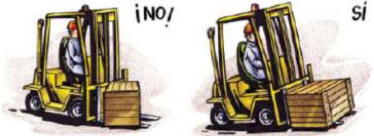
**2. Posición del mástil:** durante la circulación de la carretilla, tanto con carga como en vacío, será siempre replegado e inclinado hacia atrás.
