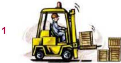
Acercarse de forma perpendicular y centrada, hasta 30 cm. del lugar en el que se va a depositar la carga.
