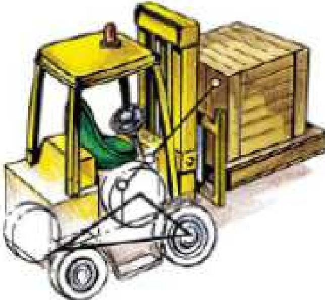
El vuelco lateral se produce con más facilidad en una carretilla elevadora que en un automóvil. Esto es debido a que el eje de dirección (eje trasero) de la carretilla se encuentra unido al chasis sólo por su parte central, formando con las ruedas delanteras un triángulo imaginario: **el triángulo de estabilidad**. Así, la carretilla elevadora se comporta como si tuviese dos ruedas delanteras y sólo una rueda trasera.
