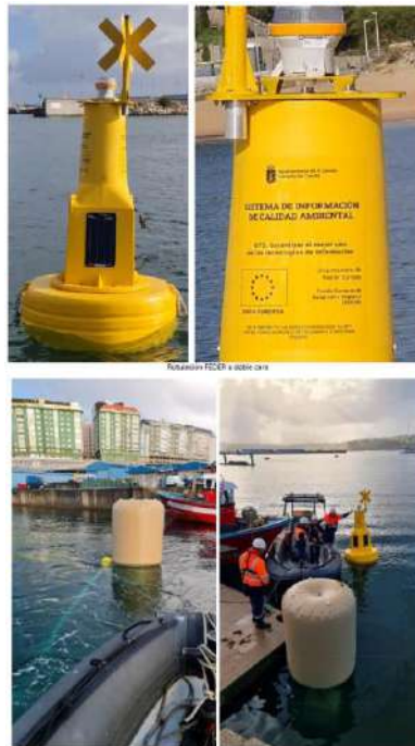
Imágenes de instalación y puesta en marcha de un sistema de control de calidad de las aguas de baño en la playa de Oza
