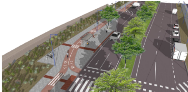
Visualización realizada a partir del documento "Actuaciones medioambientales en el polígono de A Grela: humanización y reurbanización de la calle Severo Ochoa". Vista de toda la sección de la vía donde destaca la optimización de la plataforma para destinar el espacio dedicado en la actualidad al tráfico rodado a otros usos, sin reducir el número de carriles de circulación.
